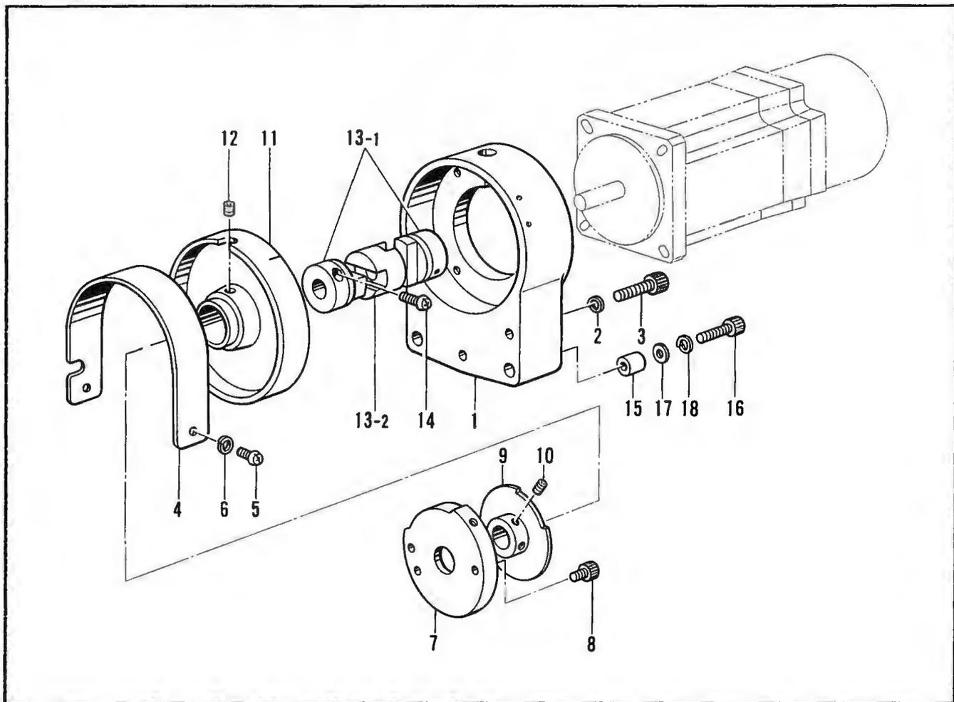
Y. 踏板関係/Foot switch pedal mechanism/Fußbetätigung/
