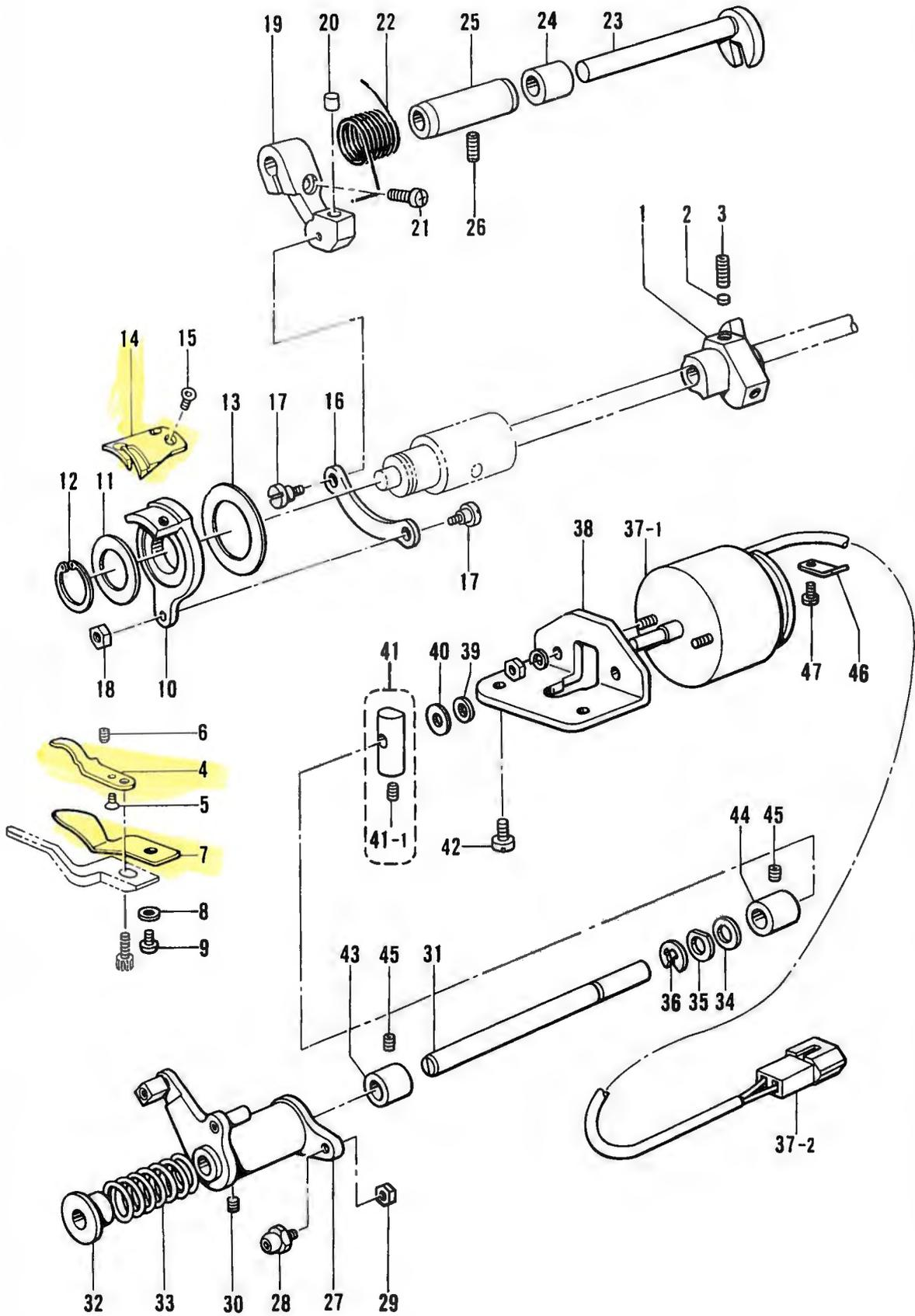
R. 糸切り関係/Thread trimmer mechanism/Fadenabschneidevorrichtung/
