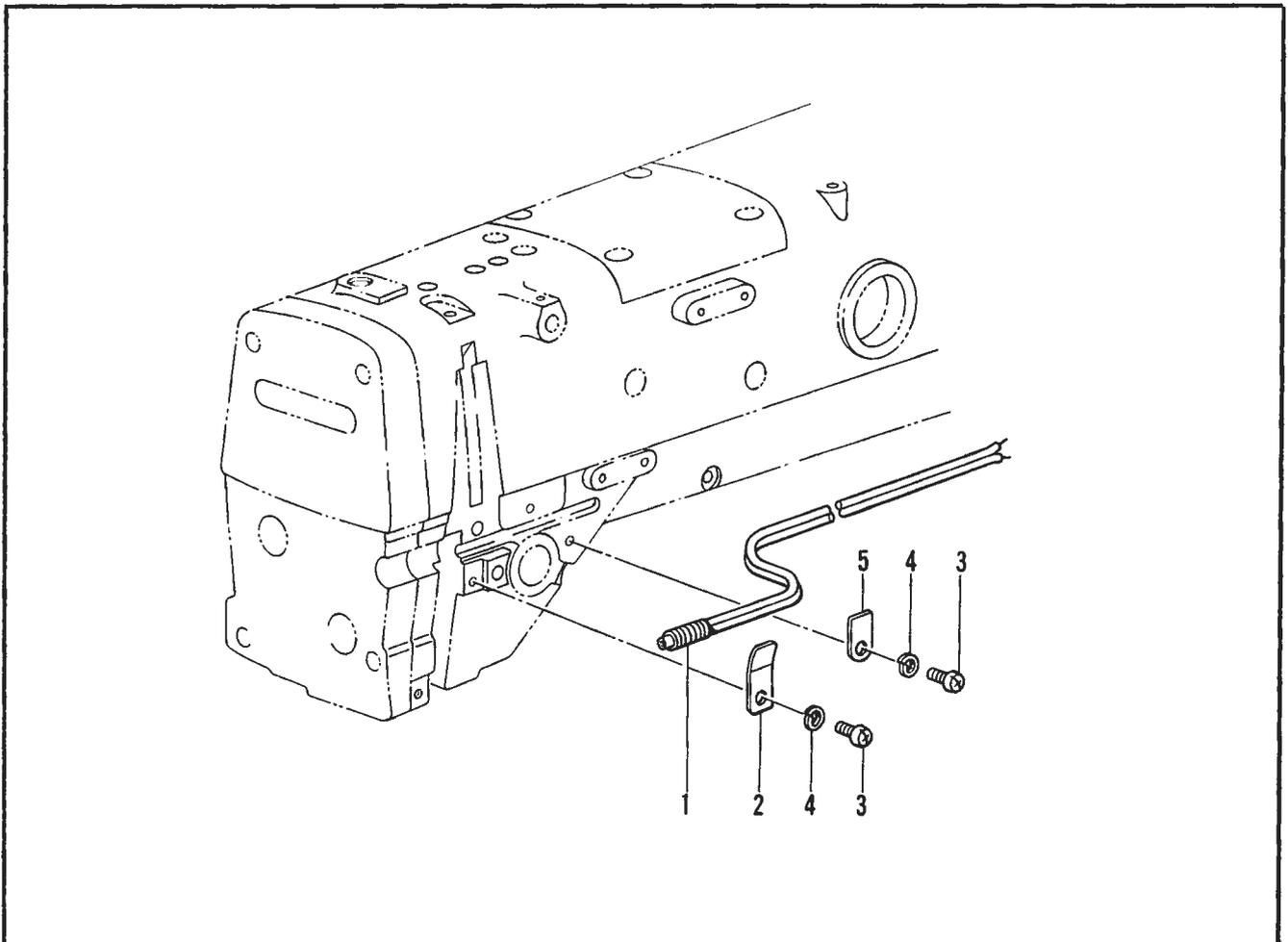
E. 針板関係 / Needle plate mechanism / Stichplattenmechanismus /
