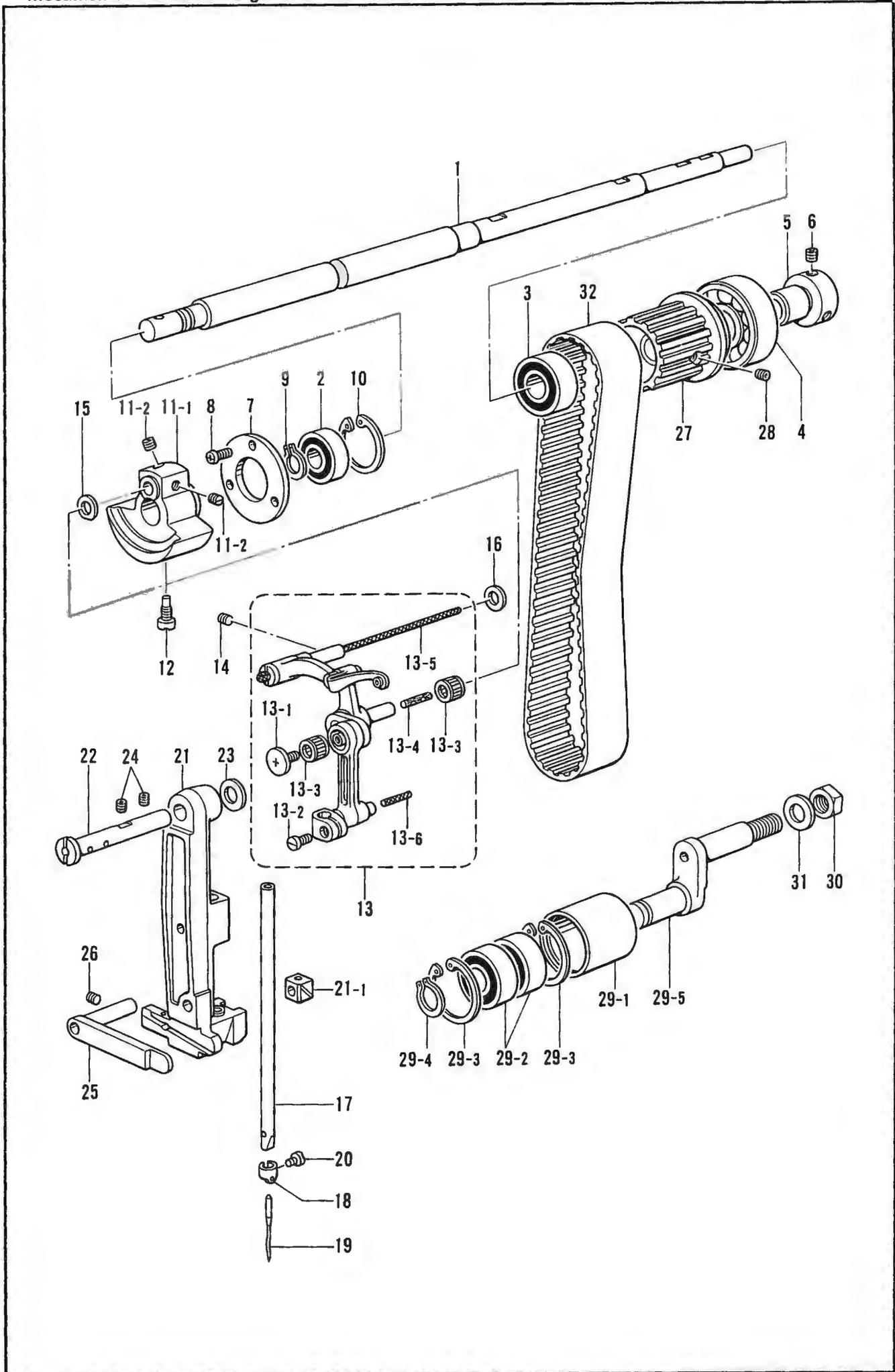
B. 針棒・天秤関係 / Needle bar and thread take-up mechanism / Nadelstange und Fadenabnahmevorrichtung /
