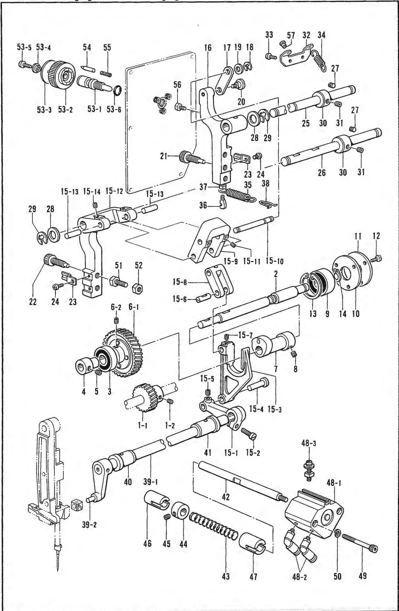
C. 針振関係/Zigzag mechanism/Zickzackvorrichtung/
