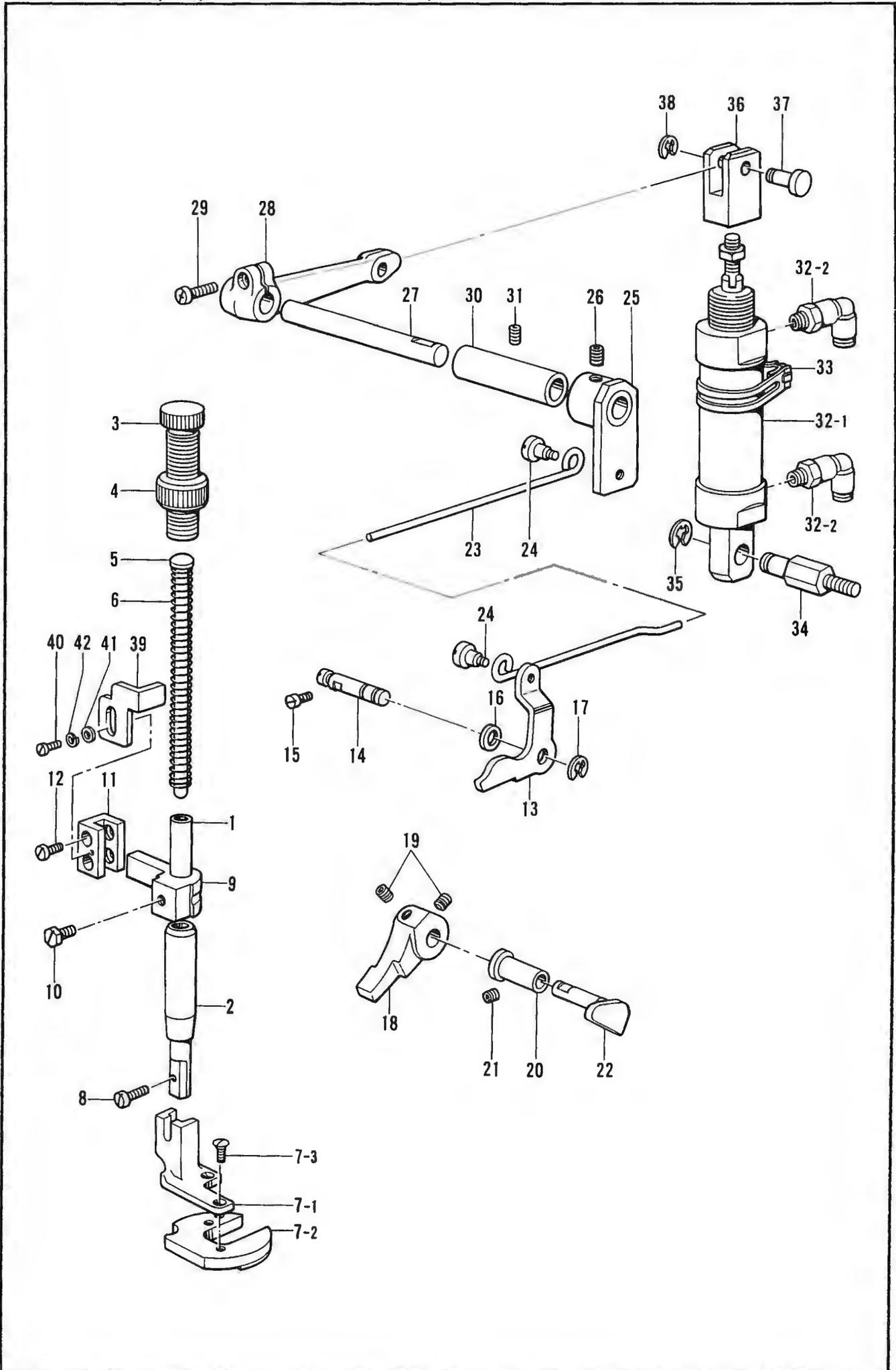
D. 押工関係/Presser foot mechanism/Stoffdrückerfuß/
