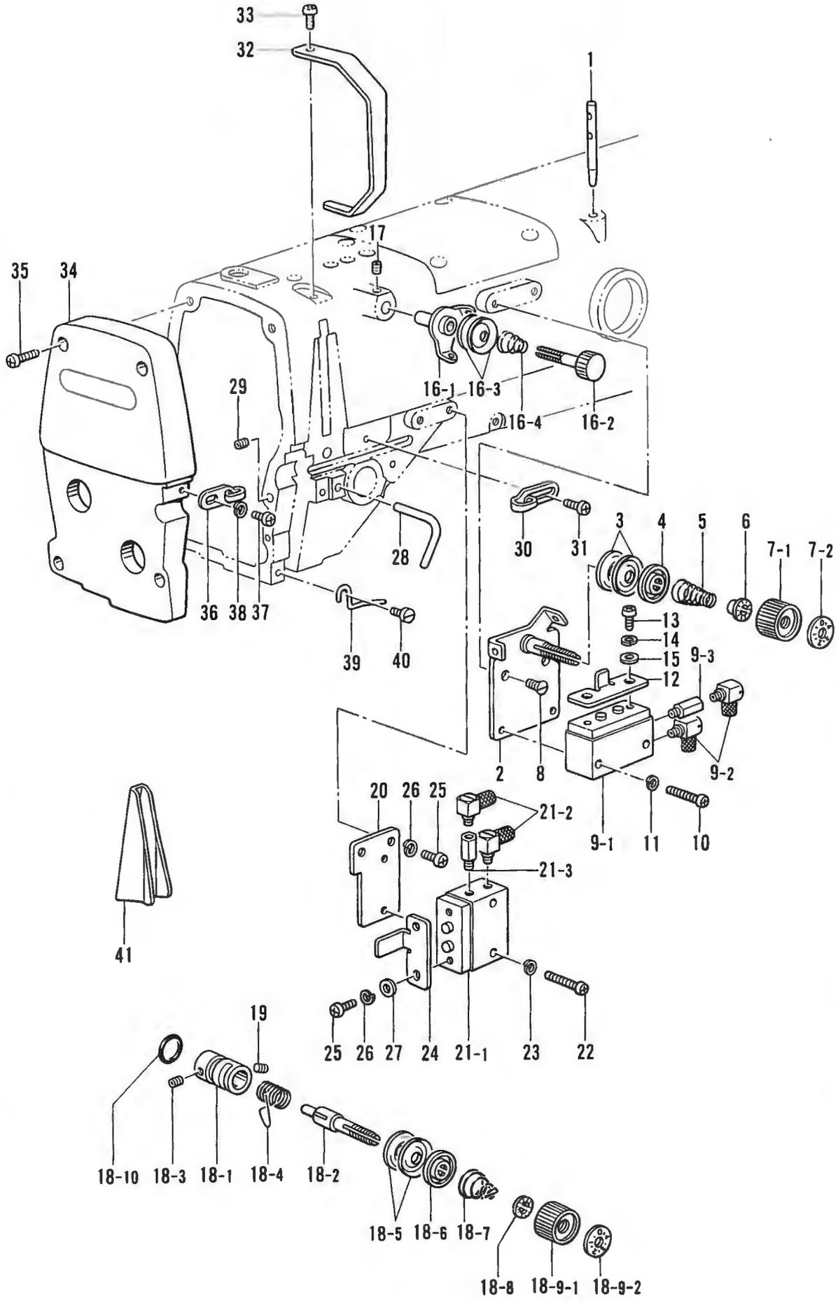
P. 糸通シ関係 / Threading mechanism / Fadenführungsrichtung /
