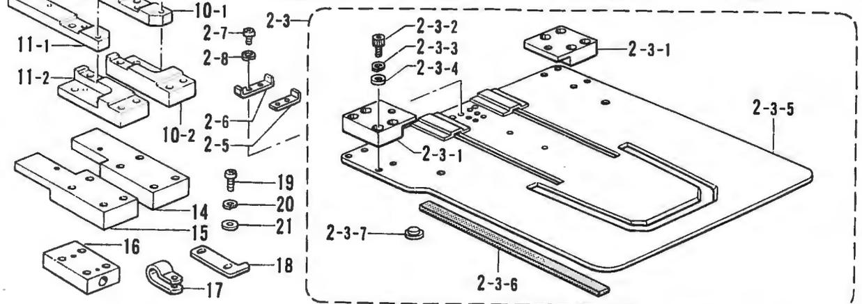
K. 折り曲げ関係 / Folding margin mechanism / Faltungsvorrichtung /
