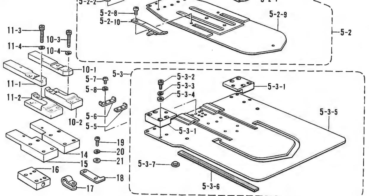
K. 折り曲げ関係/Folding margin mechanism/Faltungsvorrichtung/
