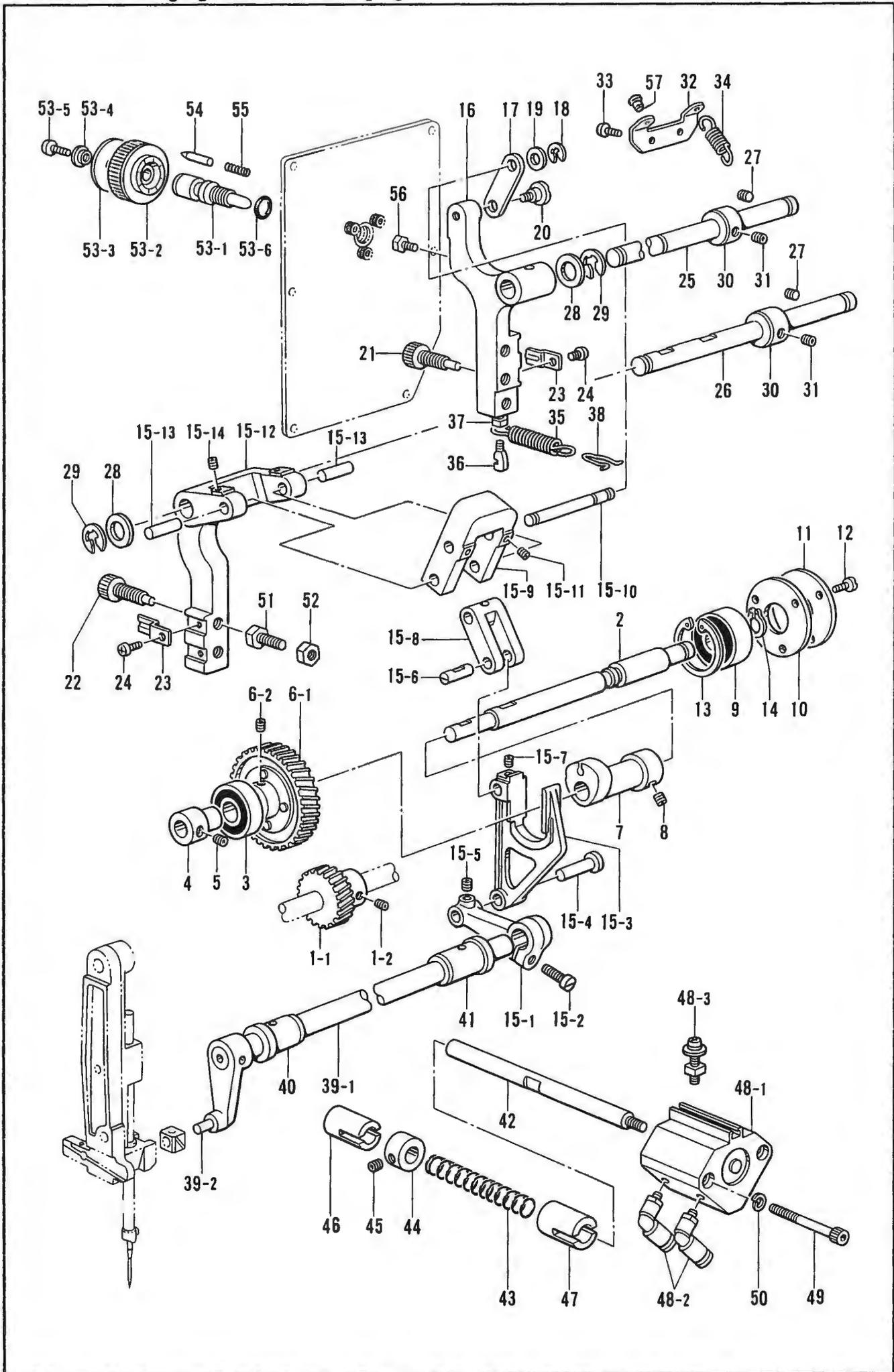
C. 針振関係/Zigzag mechanism/Zickzackvorrichtung/
