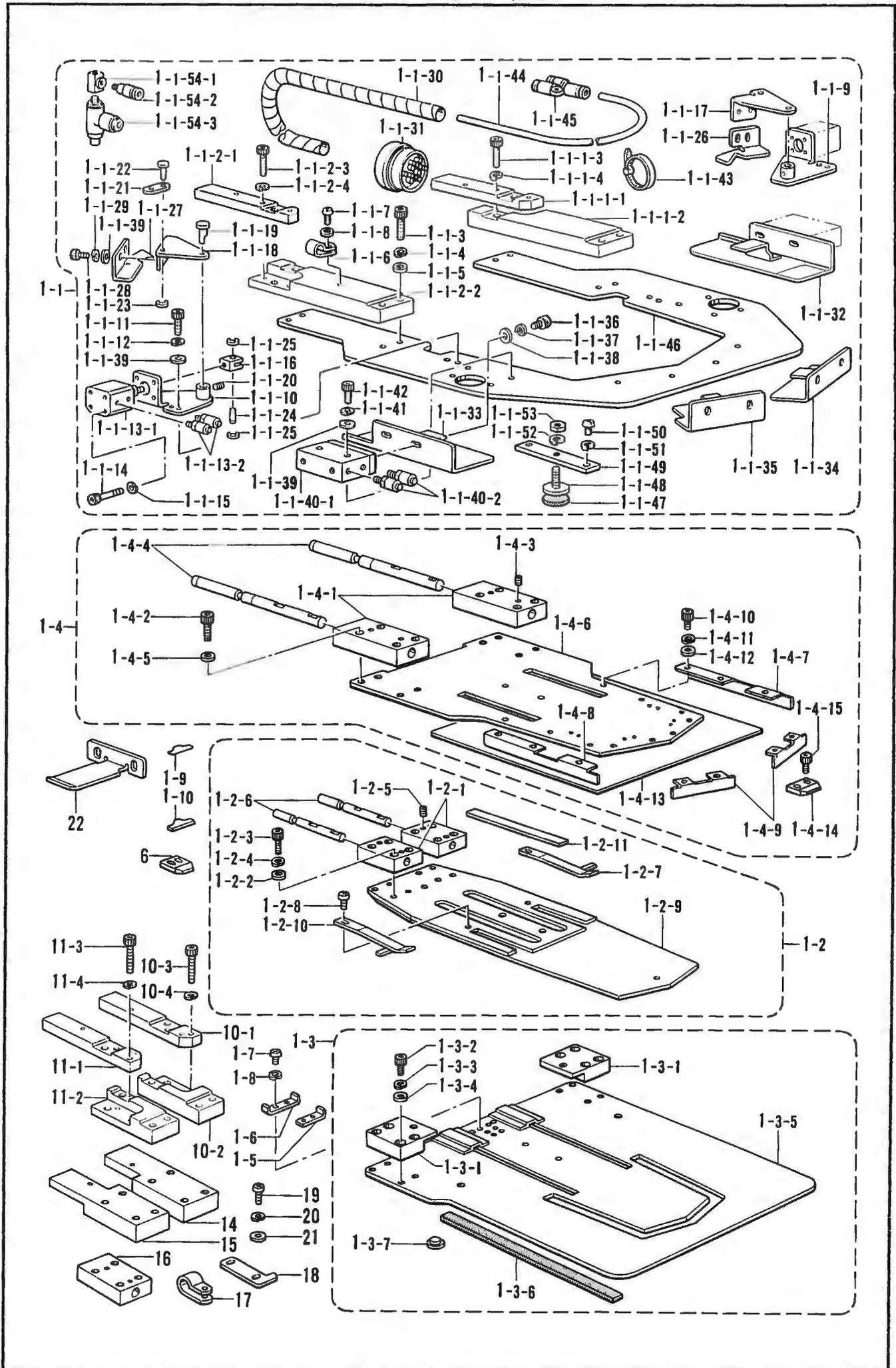
K. 折り曲げ関係/Folding margin mechanism/Faltungsvorrichtung/
