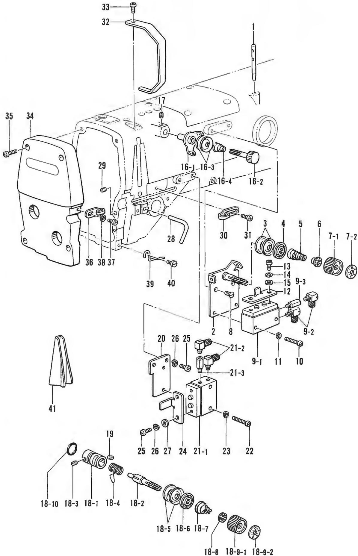
P. 糸通シ関係 / Threading mechanism / FadenführungsVorrichtung /
