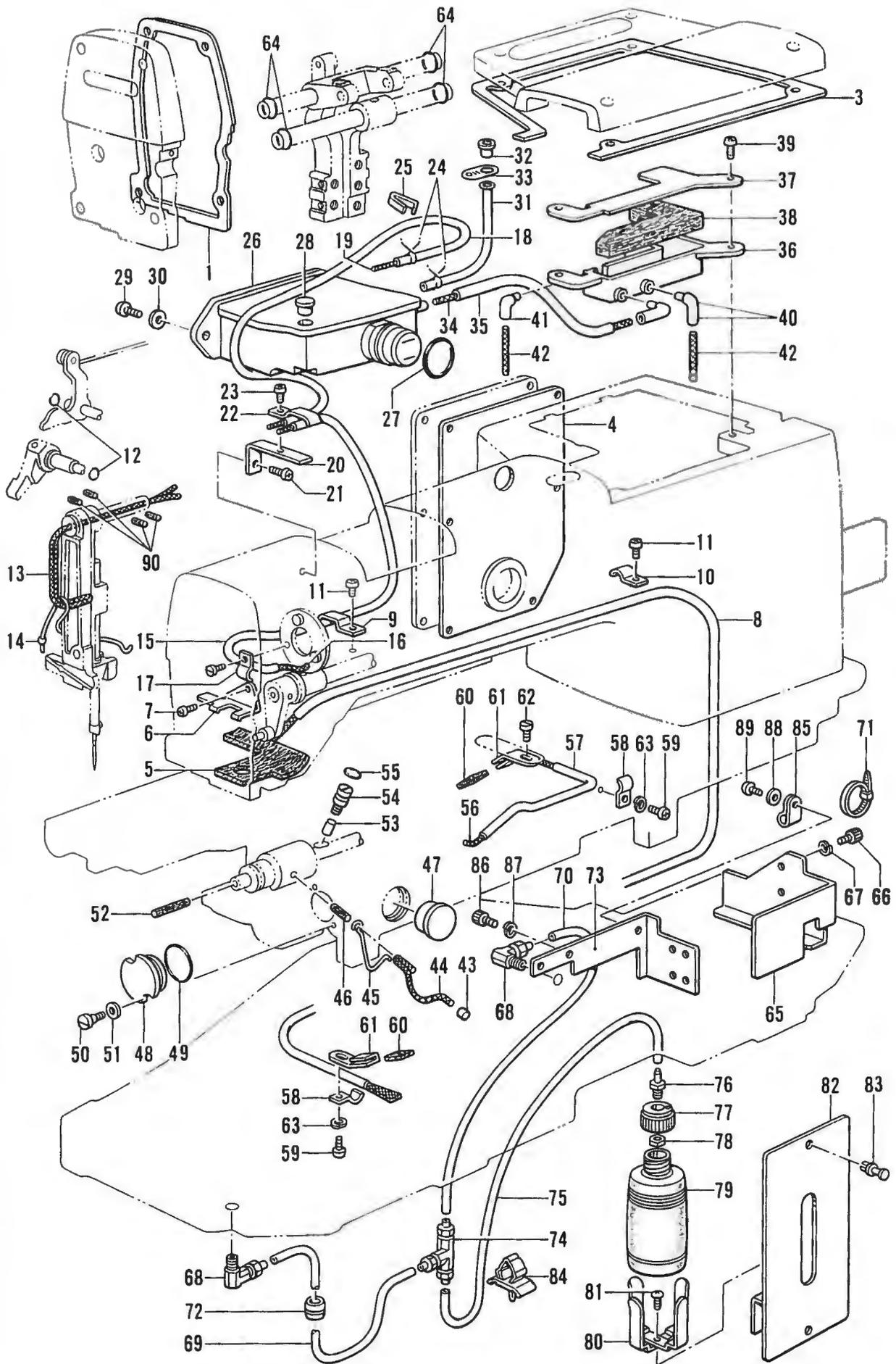
N. 給油・潤滑関係 / Lubrication / Schmierung /
