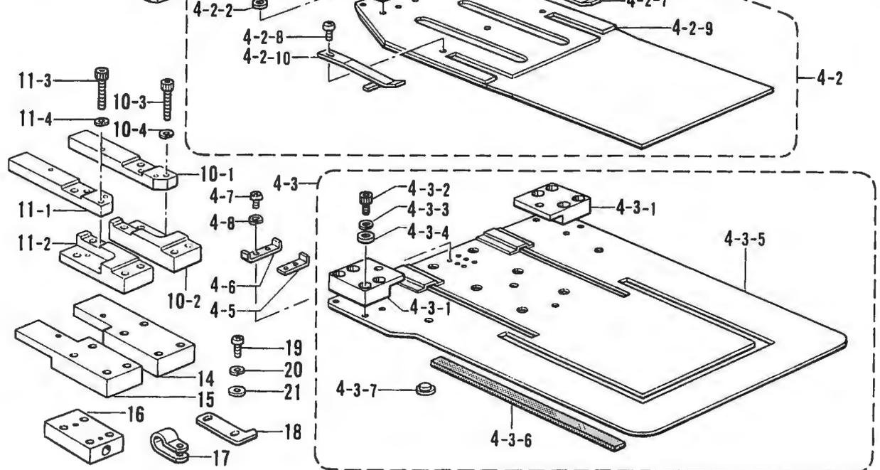
K. 折り曲げ関係/Folding margin mechanism/Faltungsvorrichtung/
