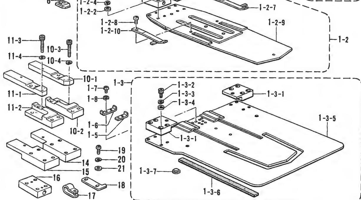
K. 折り曲げ関係/Folding margin mechanism/Faltungsvorrichtung/
