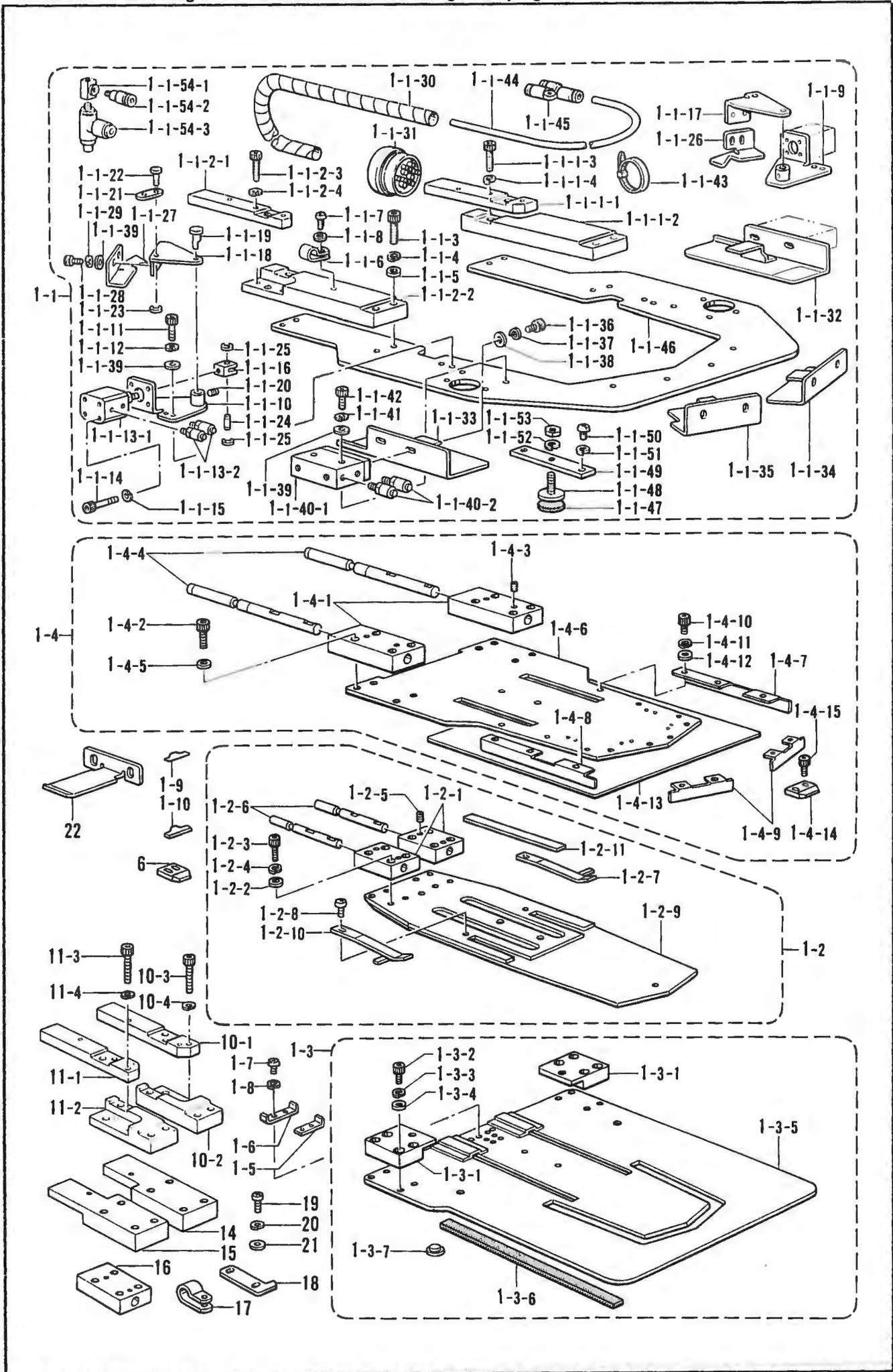
K. 折り曲げ関係/Folding margin mechanism/Faltungsvorrichtung/
