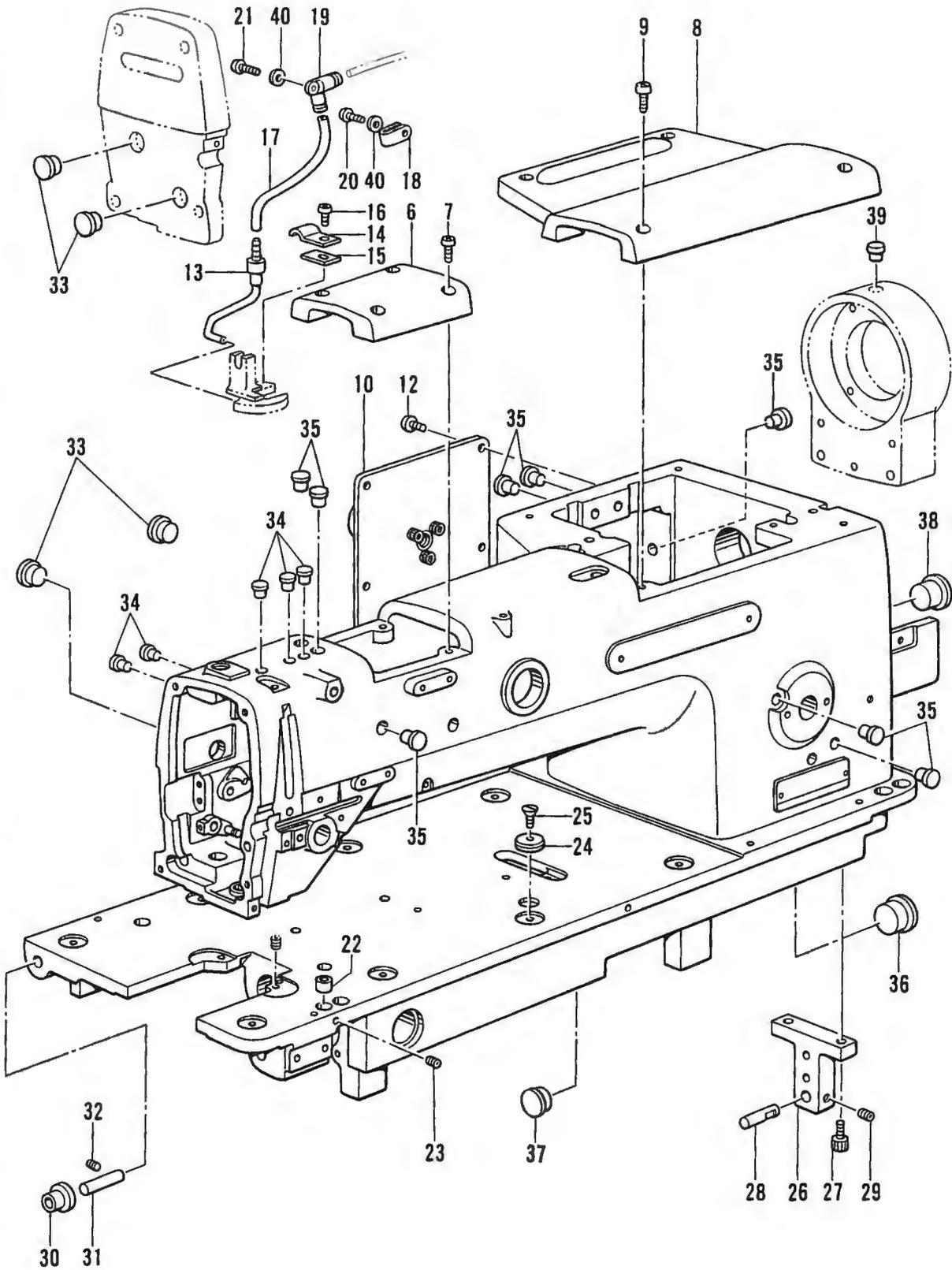
A. 主体関係/Machine body/Maschinengehäuse/
